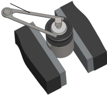
6. Stirnlochschlüssel in Stellringbohrungen einsetzen und Ring verdrehen
