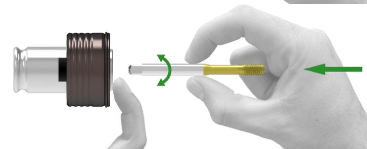
2. Gewindewerkzeug in Führungsbüchse schieben.
