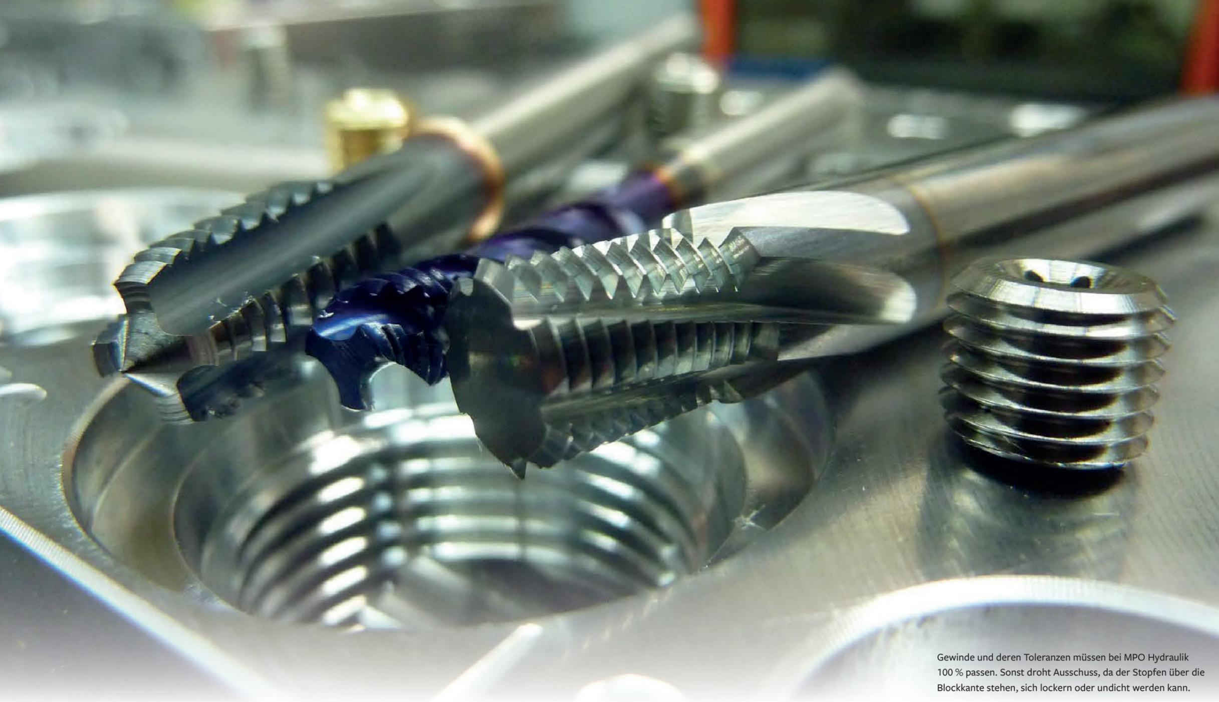
Gewinde und deren Toleranzen müssen bei MPO Hydraulik 100 % passen. Sonst droht Ausschuss, da der Stopfen über die Blockkante stehen, sich lockern oder undicht werden kann.
