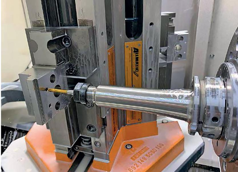
Allmatic schneidet seit 1990 mit Werkzeugen von Reime Noris seine Gewinde. Seit zwei Jahren sind auch Gewindeformer im Einsatz, die mit rund 500 min<sup>-1</sup> laufen.
