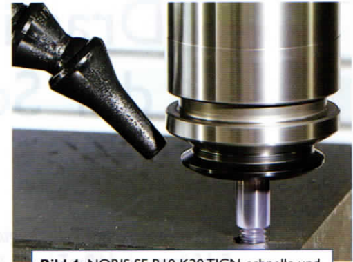
Bild 4: NORIS SF R10 K20 TiCN, schnelle und sichere Gewindefertigung bis zu 66 HRc.
