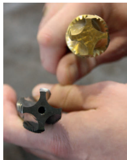
6 Oben alt, unten neu: Die Stirnansicht zeigt die deutlich größeren Spanräume des Reime-Gewindebohrers (unten)
