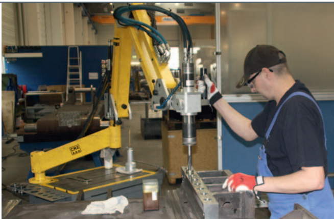
2 Walter Kraus beim Gewinden an der Gewindeschneidmaschine von CMA; die Kinematik der geführten Maschine richtet sich mittig und parallel zum Gewinde aus; die Führungsbüchse dient ausschließlich zur höheren Sicherheit beim Anschneiden
