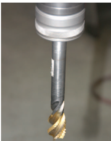
4 Der Vorgänger: Der hochspiralgenutete Gewindebohrer weist am Schaft deutliche Schleifspuren der Späne auf
