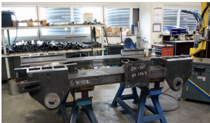
1 Grundschlitten für Drehbohrgeräte: In die massive Schweißkonstruktion sind tiefliegende Gewinde einzubringen – eine Nagelprobe für jeden Gewindebohrer
