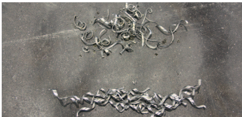
8 Spänevergleich: Der obere Spänehaufen ist das Ergebnis des Reime-Gewindebohrers, die unteren Späne hat ein noch fabrikneues Vorgängermodell erzeugt
