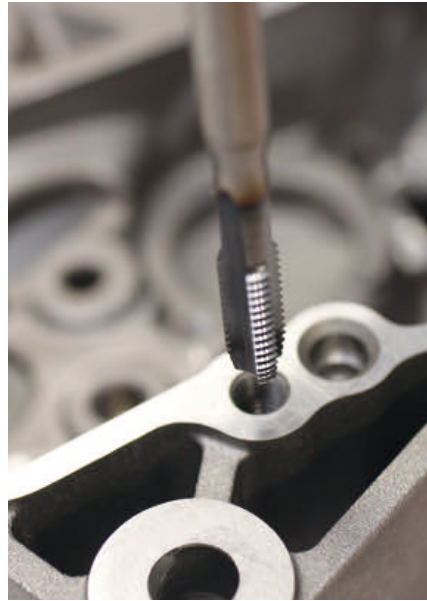
3 Die präzise Abstimmung von Schneidengeometrie und Finishbehandlung ermöglicht dem Noris Twin GGV den optimalen Schnitt in Gusswerkstoffen
