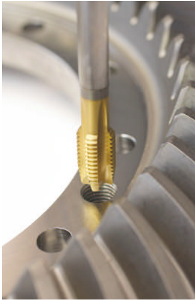
2 Noris-Gewindebohrer der HR-Reihe sind ausgelegt für die Bearbeitung hochfester und hitzebeständiger Stähle bis 1400 \text{ N/mm}^2
