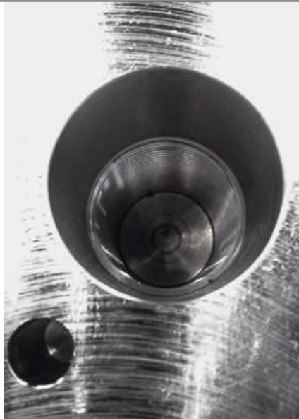
2 Lochform des Verbindungsgewindes eines zweiteiligen Kurbelgehäuses
