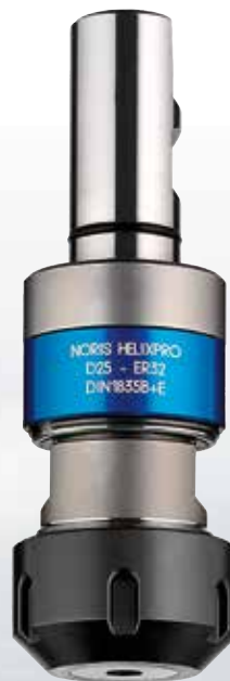
Die Drehbewegung und die axiale Ausgleichsbewegung werden beim Noris-HelixPro entkoppelt.
