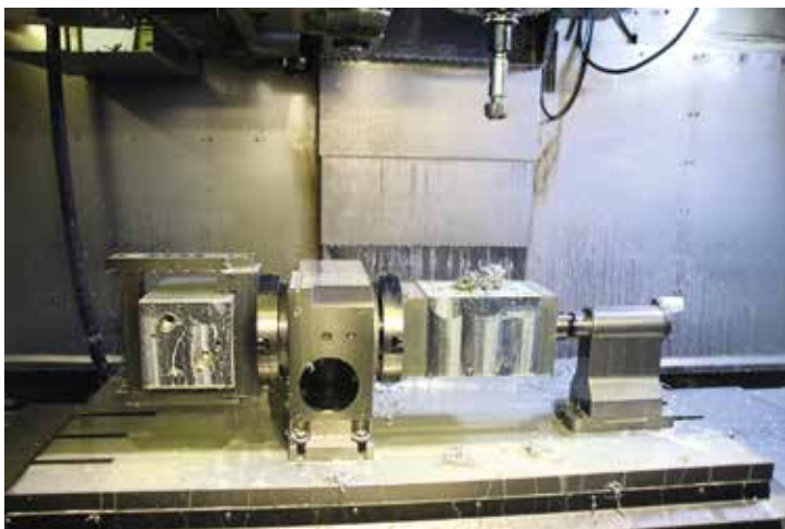
Bearbeitung von Hydraulikblöcken auf einem Hurco-Bearbeitungszentrum auf einem Spanntisch von Lehmann.
