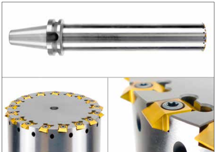
1 Dieser Gewindefräser Noris NES – hier mit SK50-Schaft, 80 mm Durchmesser, 370 mm Nutzlänge und 17 Wendeschneidplatten am Umfang – konnte unter anderem in der Großmotorenfertigung die Herstellungskosten pro Gewinde deutlich senken (© Reime Noris)
