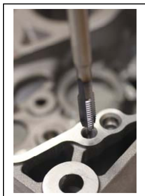
Leggenda d'illustrazione: Esempio di lavorazione con il maschio NORIS GGV
